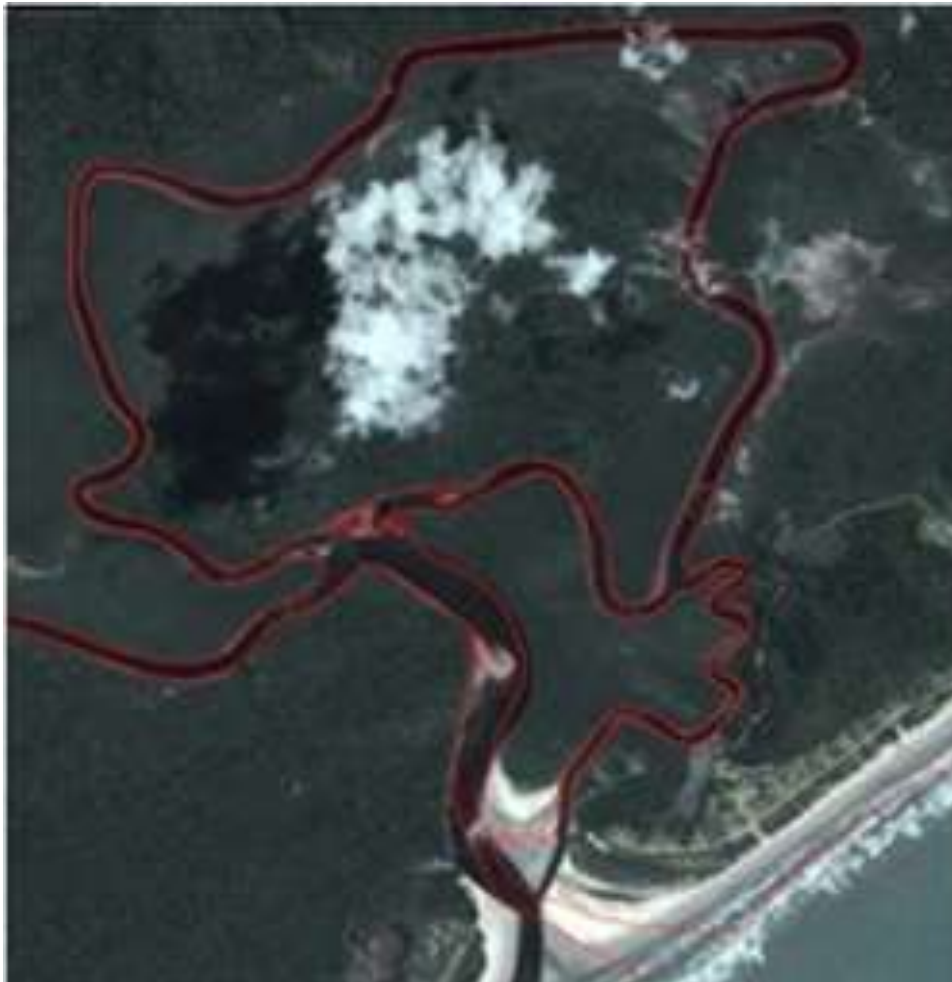
Figura 3 – Delineamento do Rio Una em 2002 (linha vermelha) sobre imagem de satélite de 2012, evidenciando o processo de erosão e deposição de sedimentos principalmente à jusante da abertura do canal e consequentemente na região mais próxima à desembocadura (Fonte Google Earth, 2012).
