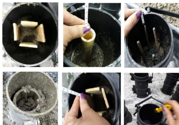
Figura 5. Moldagem dos CP's.
