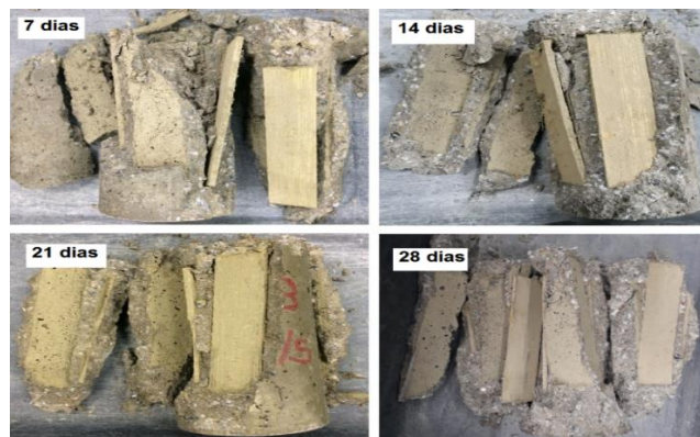
Figura 6. Ensaios de compressão axial em ripas de Bambu.
