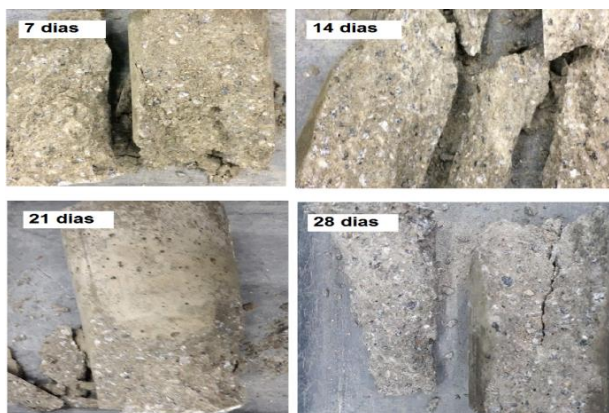
Figura 11. Ensaios de compressão axial em concreto simples.
