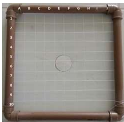
Figura 2- Transecto de 30cm 2 utilizado para quantificação e identificação de espécies no Costão Rochoso.
