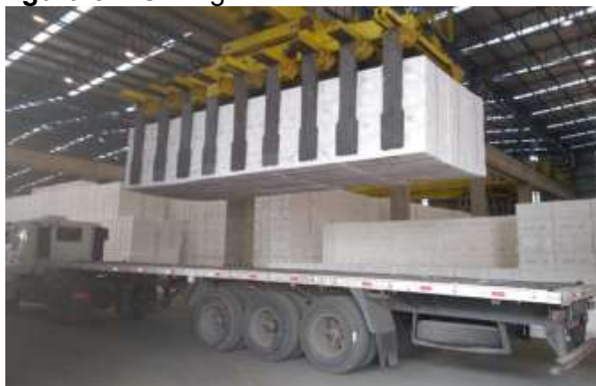
Figura 6 – Carregamento de celulose no “buffer out”
