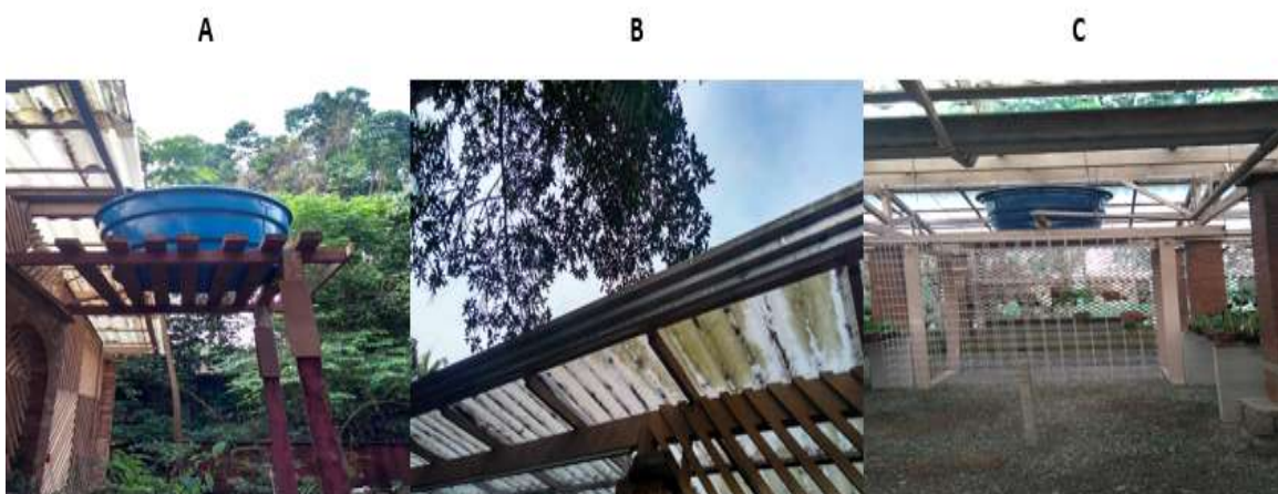
Figura 1. Pontos de coleta de água. A, Coleta de água direta da atmosfera; B, Calha de captação da água pluvial; C, Reservatório armazenamento após contato com telhado. Fonte : arquivo pessoal do autor
