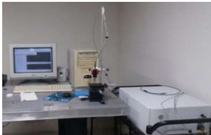
Figura 1. Sistema Raman dispersivo portátil utilizado no estudo
