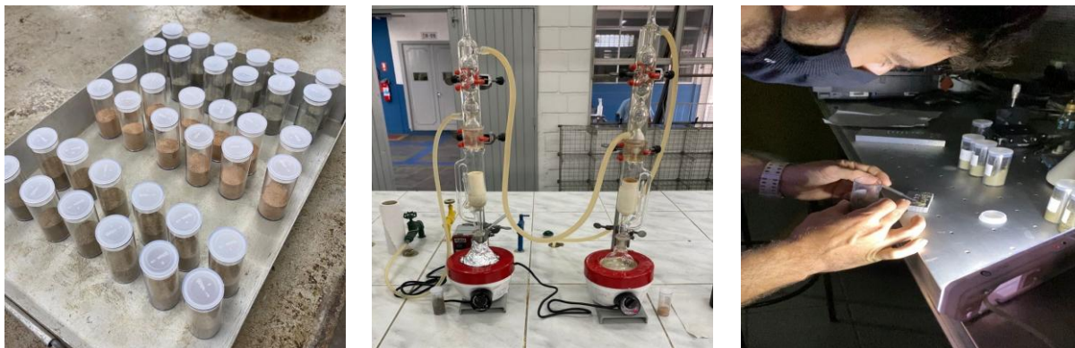
Figura 1. Fotos: A) da separação das amostras em recipientes herméticos; B) do ensaio de Landfarming; C) da análise no aparelho Raman
