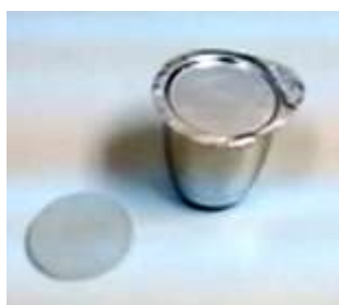
Figura 6. Cadinho de platina para fusão de amostra.
