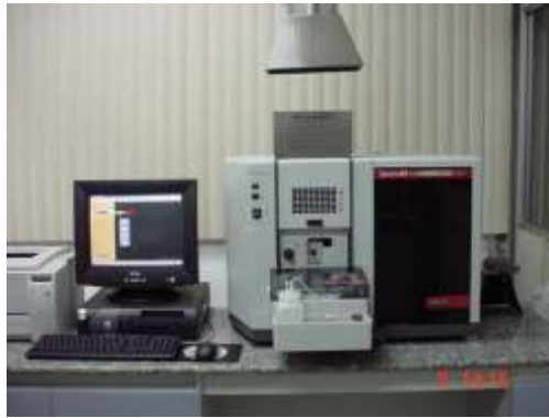
Figura 7. Espectrômetro de absorção atômica Spectra AA da Varian.
