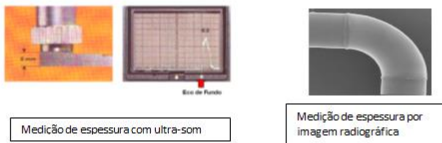
Figura 5: Medição de espessura – adaptada de Andreucci, (2005).
